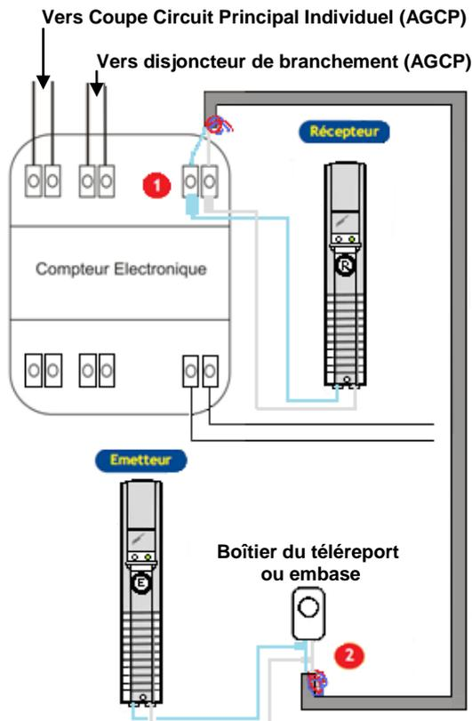
Un bus raccordé correctement est signalé par l'allumage d'une diode électroluminescente verte.
